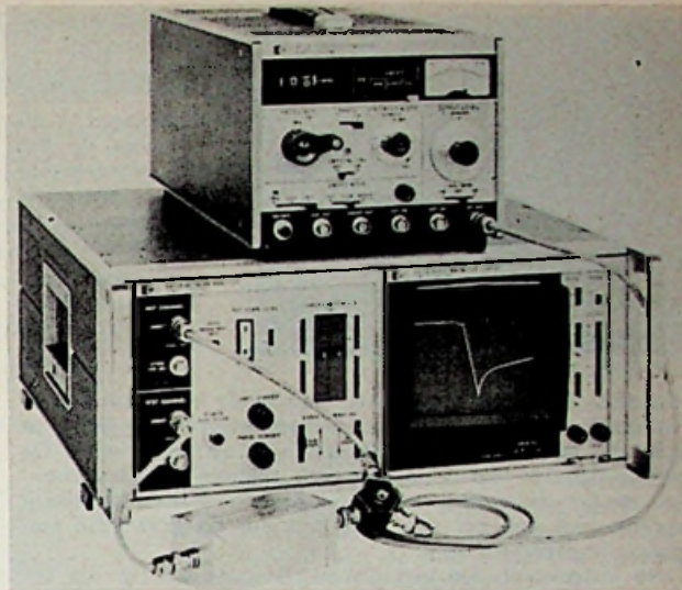
Afb. 2. De opstellingen voor transmissiemetingen. Boven: de sweepgenerator; op de voorgrond de 3 dB koppeling en het onbekende netwerk als vierpool aangesloten.
